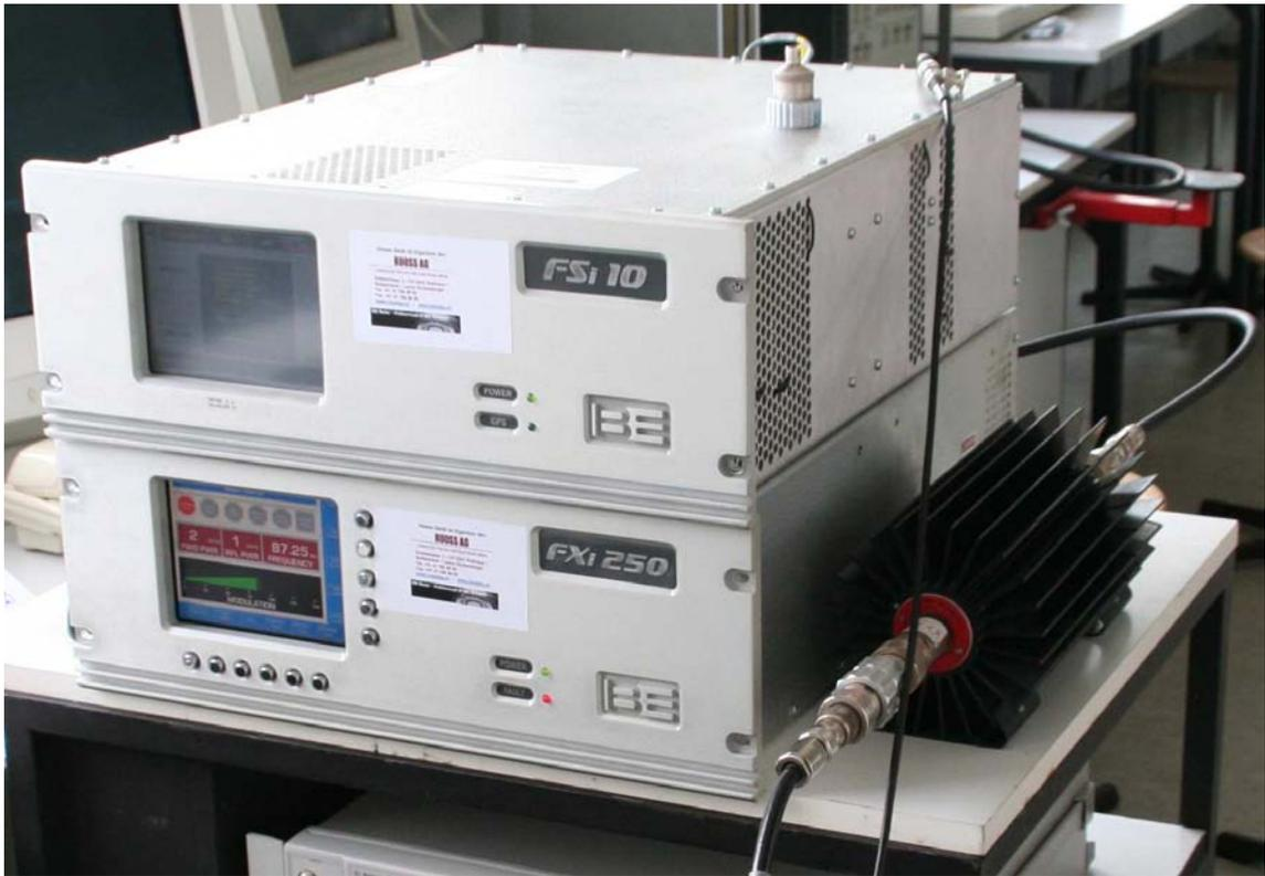
Abbildung 4.9: Foto eines HD-Radio-Senders kleiner Leistung
